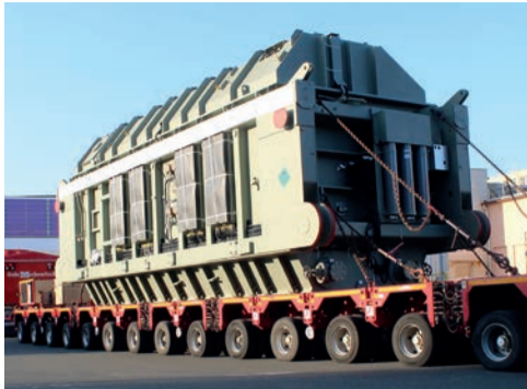
Bis zu 300 Tonnen schwer: Einer von sieben Transformatoren für den Konverter in Brunsbüttel. © TenneT
